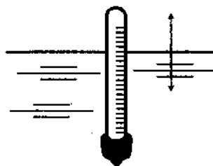
8. Однородный брускок с площадью поперечного сечения  $10^{-2} \text{ m}^2$  плавает на границе несмешивающихся жидкостей с плотностью  $800 \text{ kg/m}^3$  и  $1000 \text{ kg/m}^3$  (см. рисунок). Пренебрегая сопротивлением жидкостей, определите массу бруска, если период его малых вертикальных колебаний  $\frac{\pi}{5}$  с.
