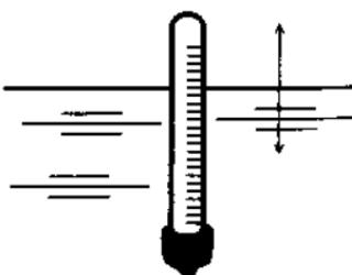
7. Ареометр, погруженный в жидкость, совершают малые вертикальные гармонические колебания с частотой 0,2 Гц (см. рисунок). Площадь сечения трубки ареометра  $10 \text{ mm}^2$ , его масса 50 г. Пренебрегая сопротивлением жидкости, найдите ее плотность.
